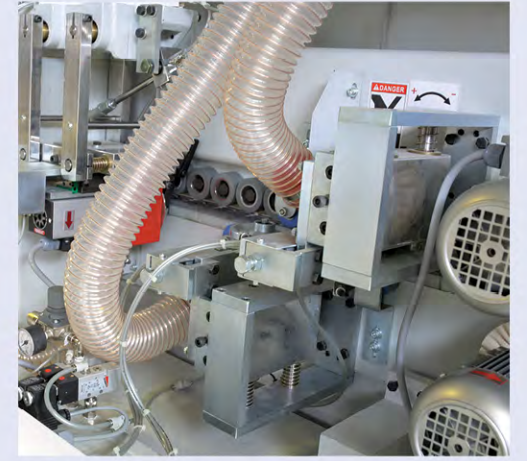
HGS (Hızlı Bant Geçiş Sistemi) HGS (Fast Edge Thickness Adjustment System)
