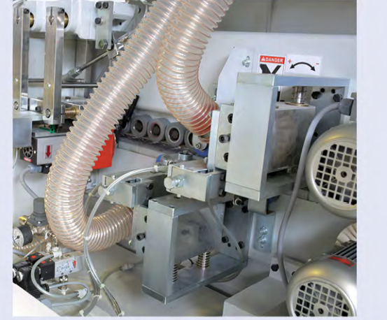
HGS (Hızlı Bant Geçiş Sistemi) HGS (Fast Edge Thickness Adjustment System)
